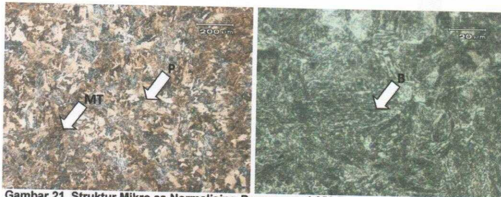
Gambar 21. Struktur Mikro as Normalising-Pemanasan I 650-Pemanasan II 250 Sumber: penulis / hasil penelitian
